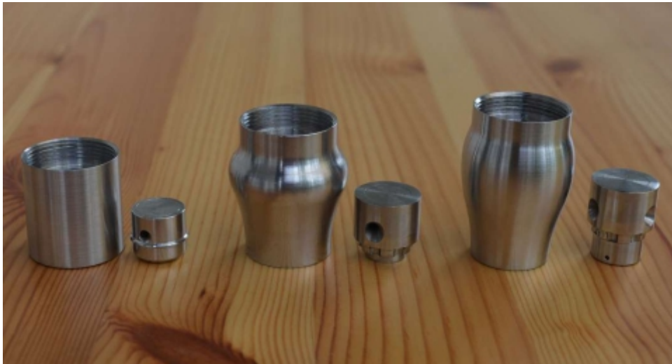
Diverse Prototypen, die zur Entwicklung des VortexPower SPRING führten nebst ihren Wirbelkammern
